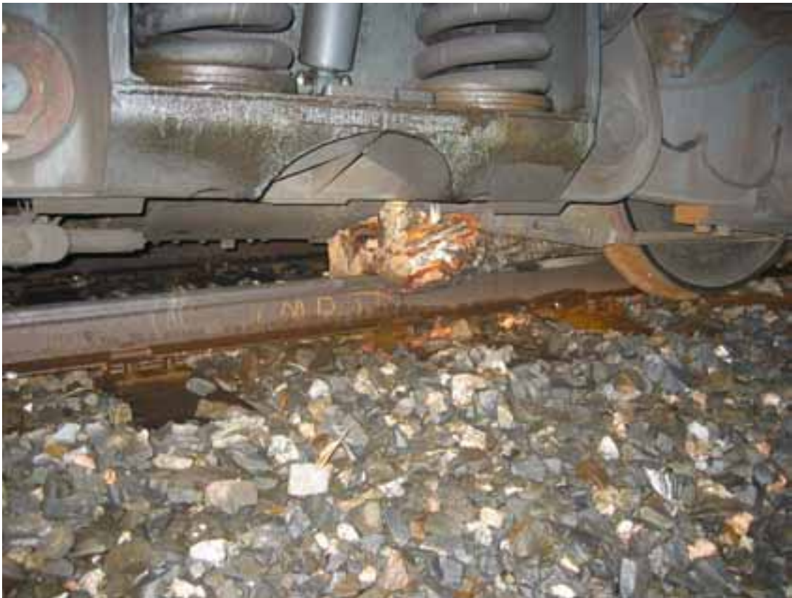
Kuva 1. Tavarajunan veturin pyöräkerran suistuminen kiskoilta Koskenkorvan liikennepaikalla 30.3.2003. Kuva suistuneesta pyöräkerrasta, sekä koivutukista veturin alla.
