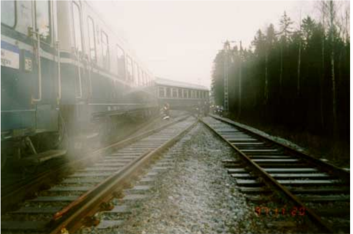
Kuva 1. Turusta Helsinkiin 20.11.97 matkalla olleen henkilöpikajunan vaihtaessa raidetta Siuntion aseman pohjoispuolella viallinen vaihde kääntyi matkustajavaunun alla. Vaunun etu- ja takapää lähtivät eri raiteille. Junan ulkopuolella ollut konduktööri havaitsi tilanteen heti ja juna pysähtyi matkustajavaunun kuljettua noin 30 metriä.
