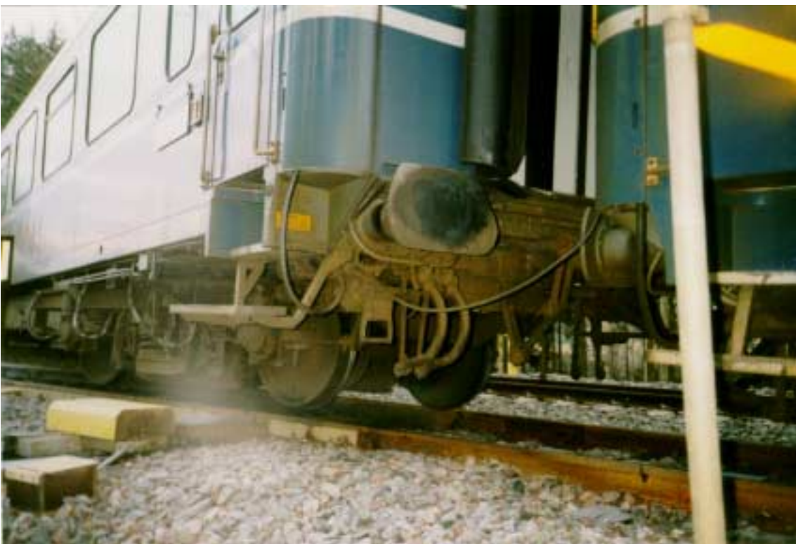
Kuva 3. Kahdelle raiteelle poikittain kääntynyt matkustajavaunu nousi ilmaan. Vedettäessä vaunua taaksepäin telit osuivat kiskoille. Onnettomuuden kokonaisvahingot olivat vähäiset.
