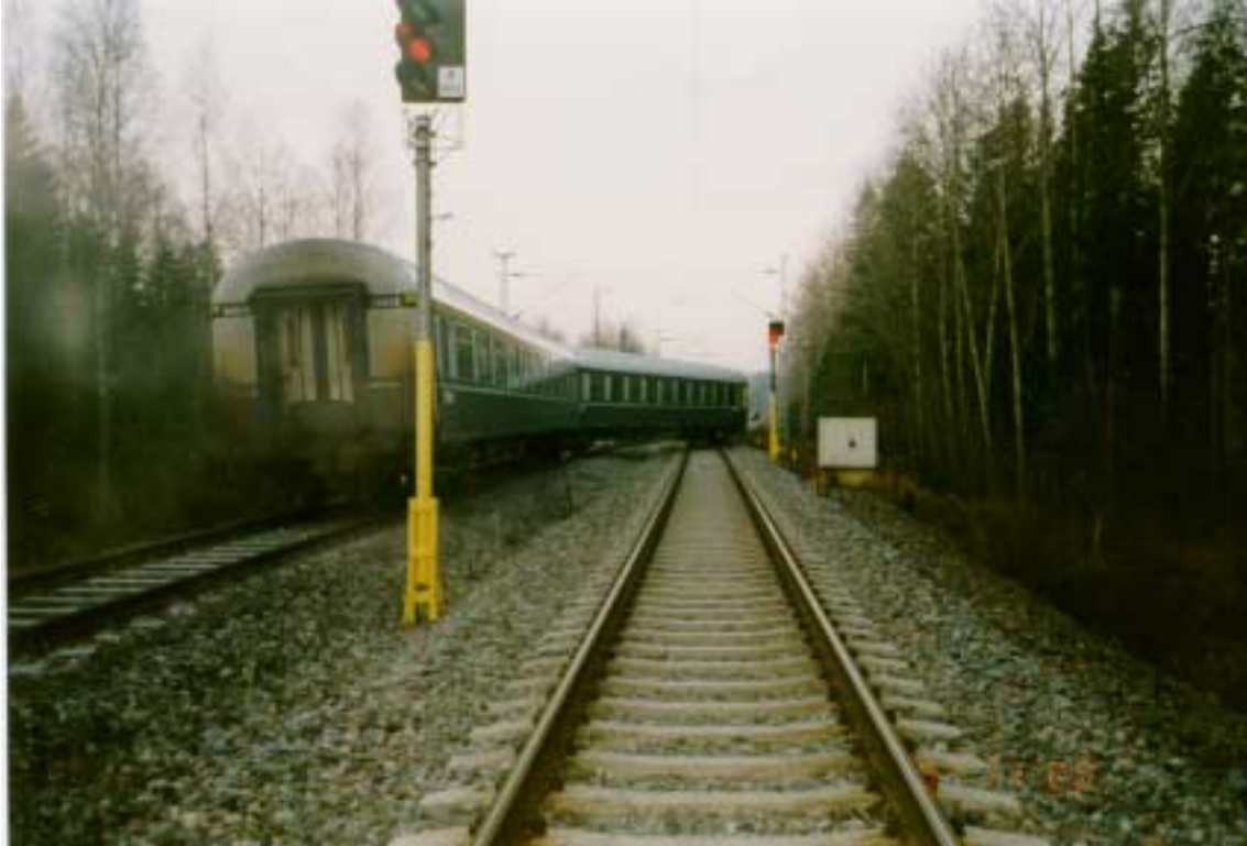
Kuva 2. Kahdelle raiteelle suistunut matkustajavaunu puristui edessä ja takana olleiden vaunujen väliin kallistuen vasemmalle. Kuva on otettu junan tulosuuntaan. Etualalla olevan matkustajavaunun edestä on veturi ajettu pois.
